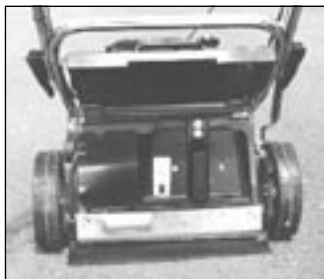
Figura 1 – Montaggio Adattatore distribuzione strame – 35m, 75m.
